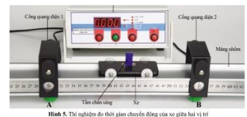
Hình 5. Thí nghiệm đo thời gian chuyển động của xe giữa hai vị trí
